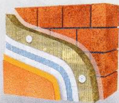
FASADA SA KAMENOM VUNOM
