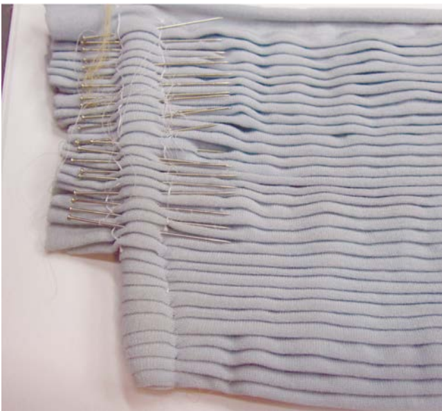
4. A fluting technique, which involves sewing along the entire edge of the pleat, was used by Madam Grès to create the yoke on Princess Barbara's gown. 4. Мадам Гре је на раменици хаљине кнегиње Барбаре користила технику плисирања која подразумева прошивање дуж читавог руба плисираног блока
